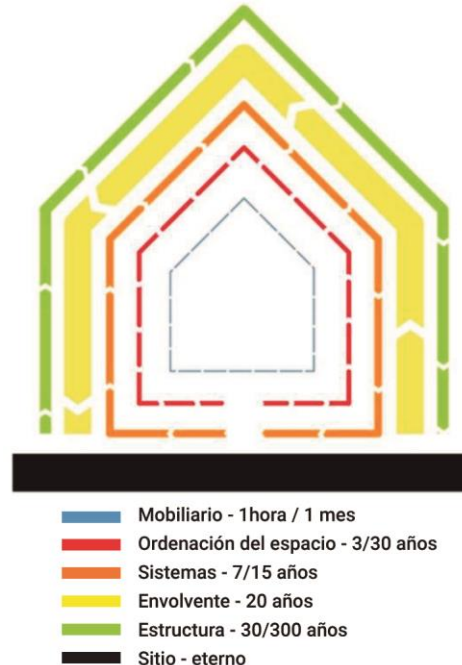
Figura 2. Capas funcionales en un edificio. Romnée & Vrijders (2017). Adaptación de Brand (1994)
